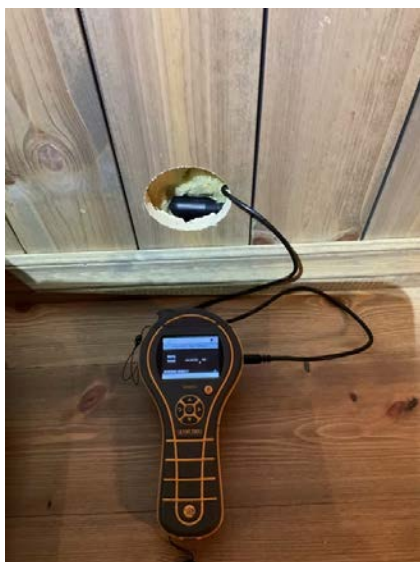
Det er foretatt hulltaking med 73 mm hullbør fra tilstøtende rom (soverom). Undersøkelsen viser ingen tegn til skader eller fukt i konstruksjonen.
