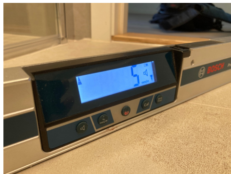
Målt fall ved dør
