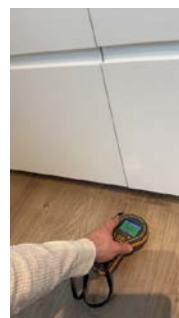
Fukt søk ved bruk av indikasjon foran oppvaskmaskin. Uten å avdekke unormale forhold.
