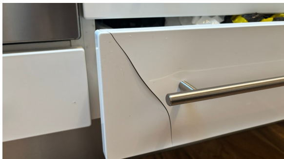
Sprekker i folieringen på kjøkkenet
