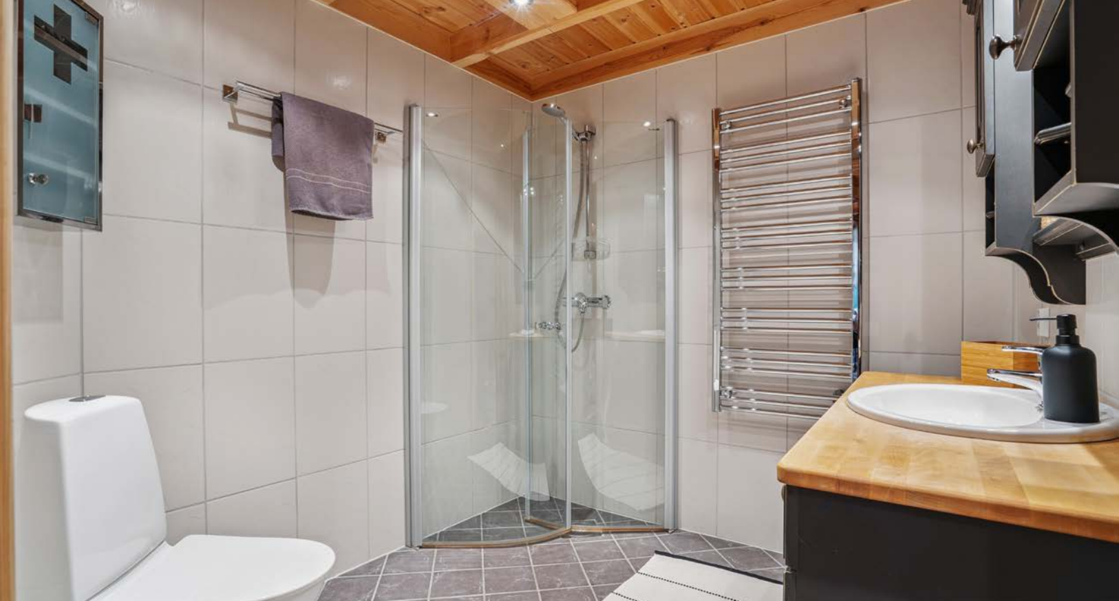
Flislagt baderom med elektriske varmekabler i gulv. Rommet inneholder gulvmontert toalett og dusjhjørne med innfellbare glassdører og veggmontert dusj.
