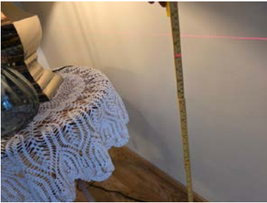
71,5cm ved yttervegg (innenfor 2m)
