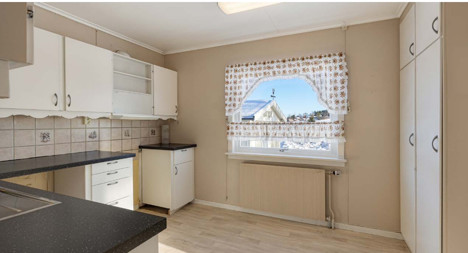
Innredningen har hvite, glatte fronter, benkeplate av laminat og dobbel oppvaskkum i stål. Over benken er det belysning og lysegrå fliser med noe dekor, og over kokesonen er en ventilator etablert med avtrekk ut.
