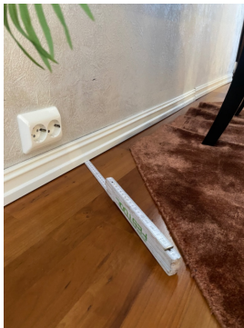
Måling av planavvik innenfor 2 m, i stuen.
