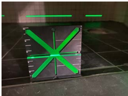
Måling av fallforhold fra nedsenking i dusjnisen.
