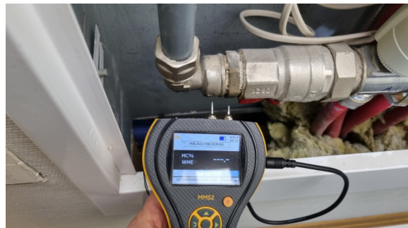
Ingen forhøyde fuktverdier ble registrert.
