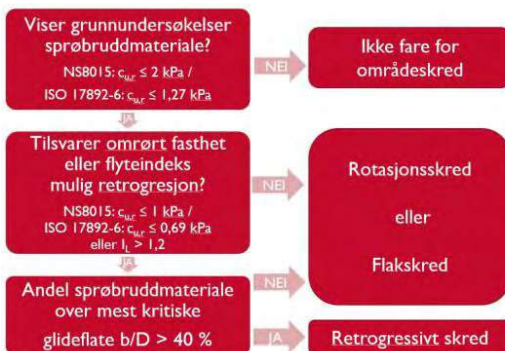
Figur 3-2: Flytskjema for vurdering av aktuelle skredmekanismer, hentet fra NVEs veileder 1/2019, kap. 4.5.1 [1].
