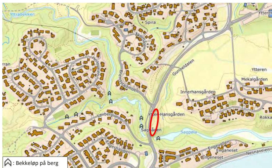
Figur 3-1: Oversiktskart av bekkeløp på berg, markert med svarte markører. Pågående erosjon markert med rødt.
