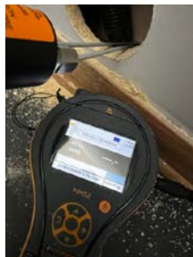
Hulltaking/ fuktmåling bak dusjhjørnet
