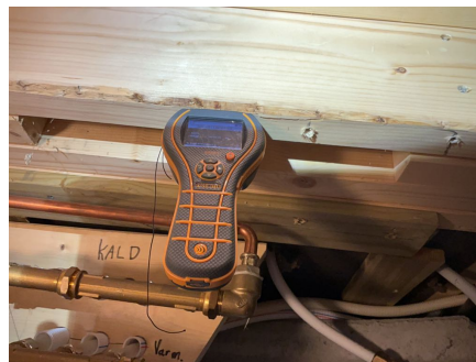
Enkel fuktmåling i etasjeskiller teknisk brønn viste tørre verdier.
