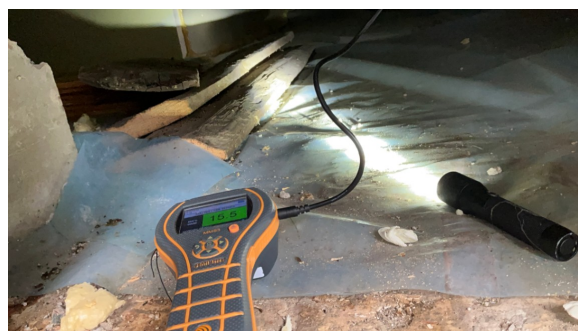
Fuktmåling i etasjeskiller i krypkjeller viste tørre verdier.
