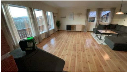
1. etasje Plassering av laser ved kontroll av stue. Det er målt 20 mm høydeforskjell gjennom rommet. TG 2
