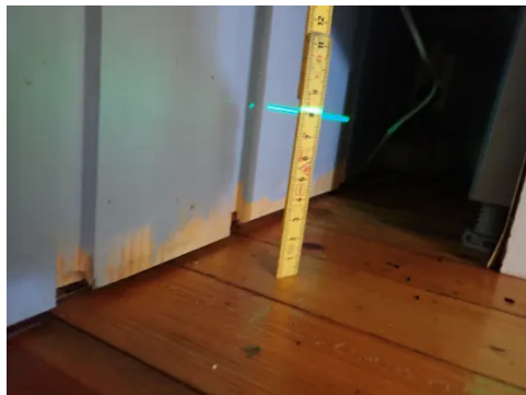
Referansenivå laser = 40 mm. Viser avvik på ca. 42 mm i kjøkken.
