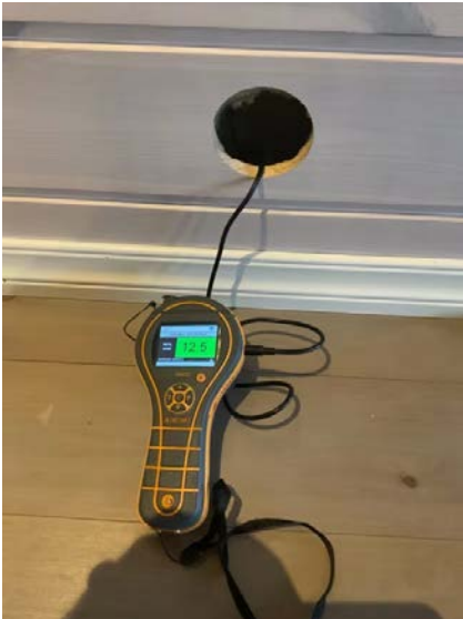
Hulltaking i tilstøtende rom.
