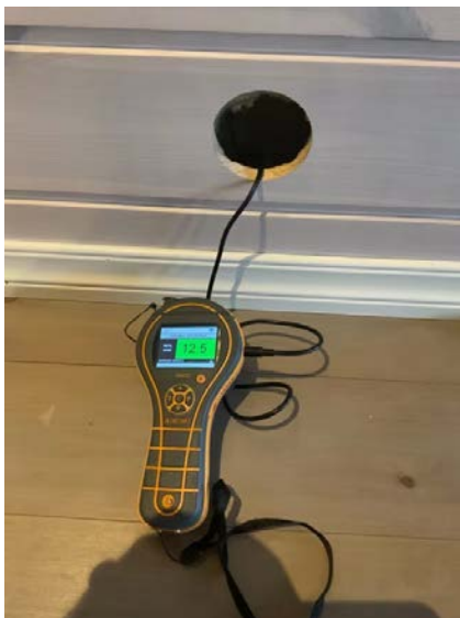
Hulltaking i tilstøtende rom.
