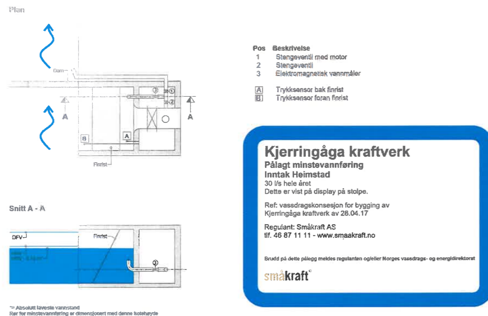
Figur 7: Prinsipp for slipp av minstevannføring sideinntak
