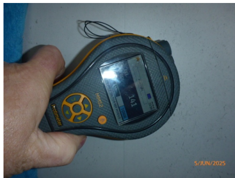
144, plateskjøt oppe på vegg ved toalett utenfor dusjnisen
