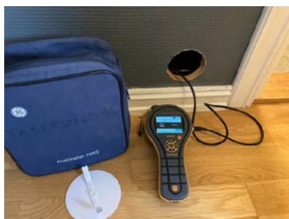
Fuktmåling uten avvik. Ved målinger under 7,8 % vil displayet ikke vise resultat.
