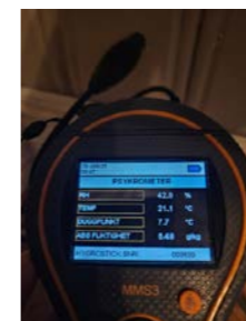
Måling av relativ luftfuktighet i lukket veggkonstruksjon mellom gang og bad. Måling av trefukt i lukket veggkonstruksjon mellom gang og bad.
