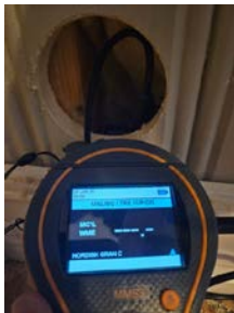
Måling av trefukt i lukket veggkonstruksjon mellom gang og bad.
