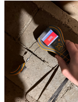
Indikerer fukt på kjellermur ved fuktsøk
