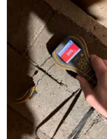
Indikerer fukt på kjellermur ved fuktsøk
