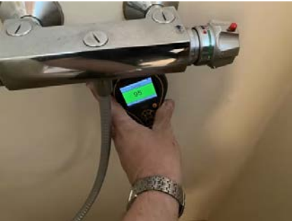
Foto viser eksempel på overflatesøk i dusjsonen, vurderes tørt.
