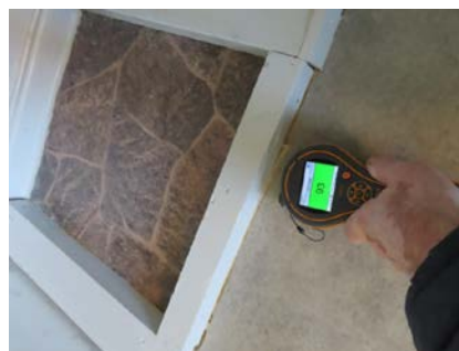
Fuktsøk på gulv foran benkeskap og oppvaskmaskin - ingen påviste forhøyede fuktverdier. (Plass for oppvaskmaskin)
