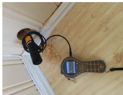
Fuktsøk mot våtrom - Naturlige utslag - ingen forhøyede fuktverdier.
