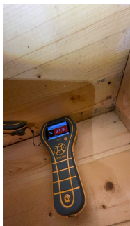
Fukt målt på panel på innforet grunnmur. Synlig plast bak panel.
