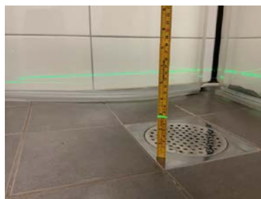
Målt fall til sluk: 21mm.
