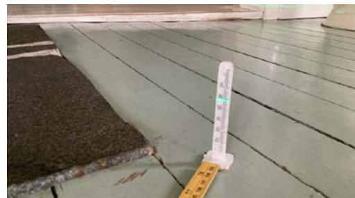
ca 29 mm høydeforskjell på gulv i stue
