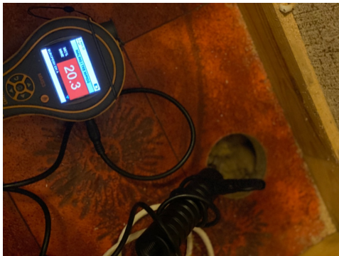
Fuktmåling foretatt med Protimeter MMS2 med pigger mot treverket i oppoforet gulv.
