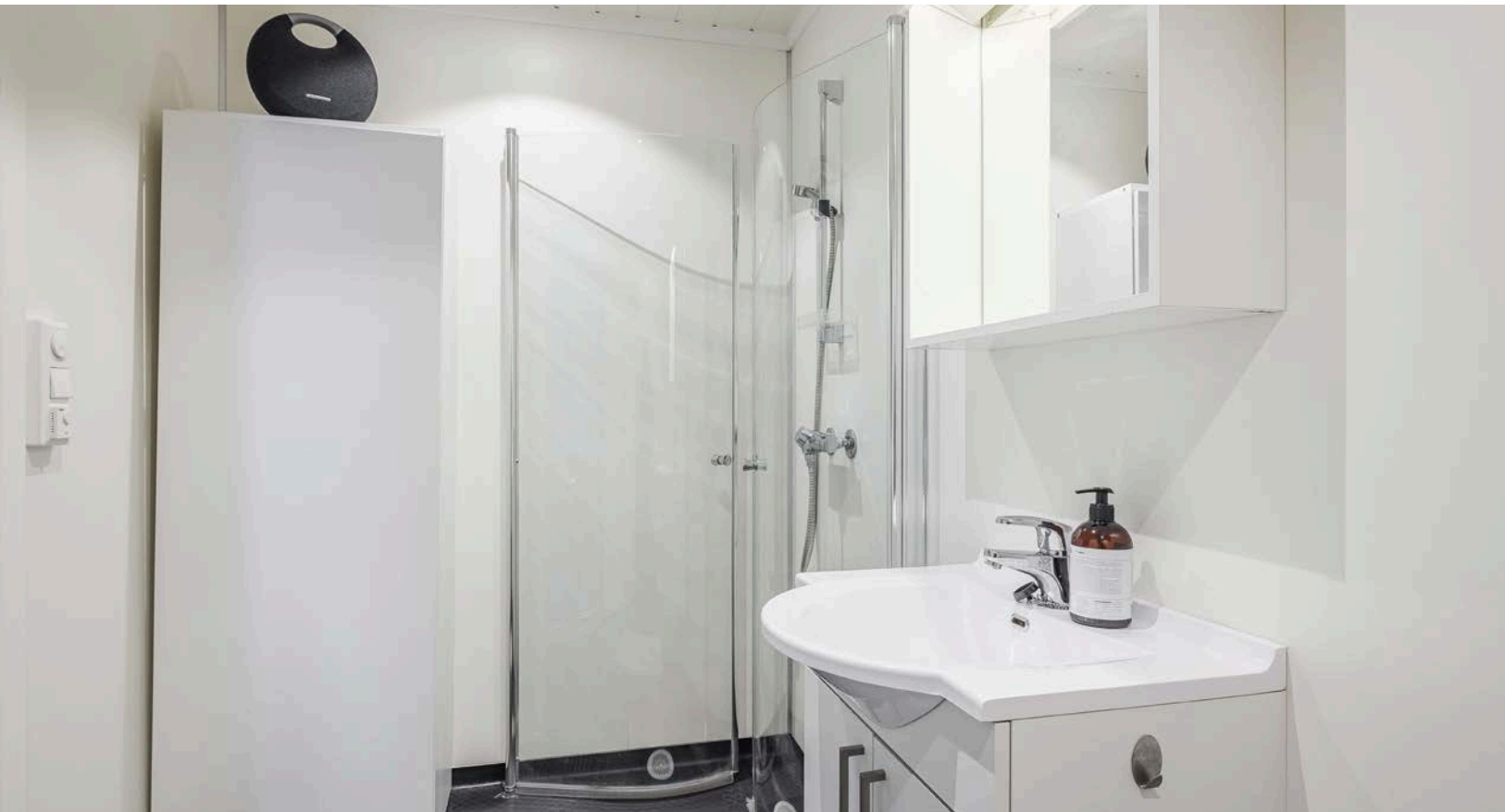
Baderommet har belegg på gulv med gulvvarme, lyse våtromsplater på veggene, downlights i himlingen og balansert ventilasjon.
