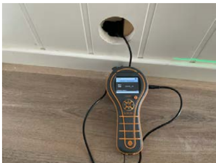
Hulltaking i tilstøtende rom.
