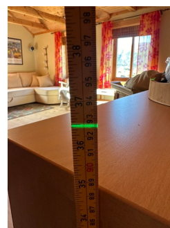
Stue 2.etg. 92,7cm. 25mm målt i en lengde på 2m.
