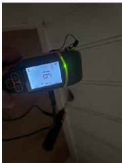
Måling av fukt i svill/påforet vegg med pigger.
