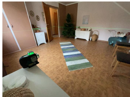
2. etasje Plassering av laser ved kontroll av soverom 3. Det er målt 15 mm høydeforskjell gjennom rommet. TG 2
