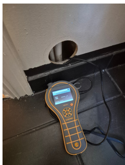
Målt vektprosent under 6% som er tørt tre.
