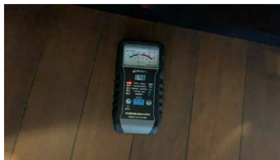
Ingen indikasjoner på fukt rundt utsatte hvitevarer.
