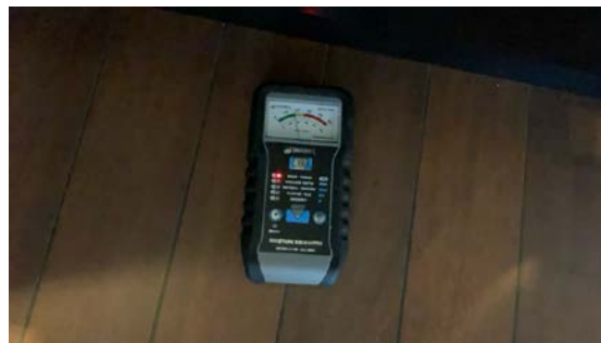
Ingen indikasjoner på fukt rundt utsatte hvitevarer.
