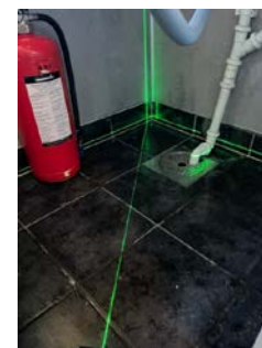
Lasermåling viste lite fall mot sluk.
