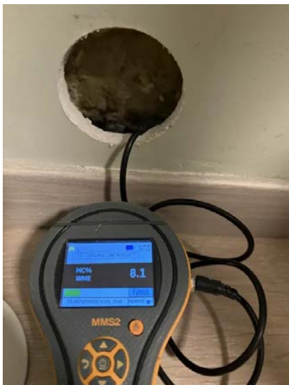
Undersøkelsen i tilstøtende rom viser ingen tegn til skader eller fukt i konstruksjonen.
