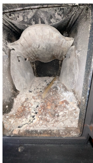
Slitte sideplater i brenn kammer på vedovn
