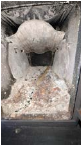
Slitte sideplater i brenn kammer på vedovn
