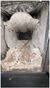
Slitte sideplater i brenn kammer på vedovn
