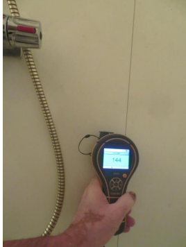
Overflatesøk i dusjsone - normale verdier, ingen påviste avvik.
