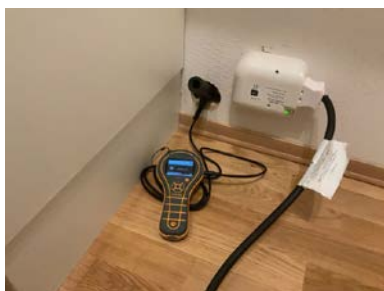
Hulltaking utført fra tilstøtende rom.
