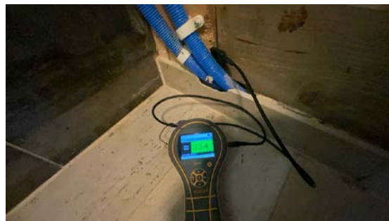
Bilde viser fuktmåling utført i tømmervegg ved tidligere plassert dusjkabinett.
