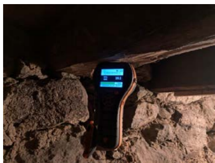
Det ble ikke målt skadelig fukt i treverk.
