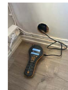
Fuktmåling uten avvik. Ved målinger under 7,8 % vil displayet ikke vise resultat.
