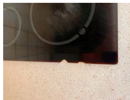
Skade på koketopp.
